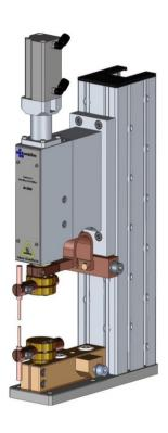
Maximal 500 N Schweißkraft
