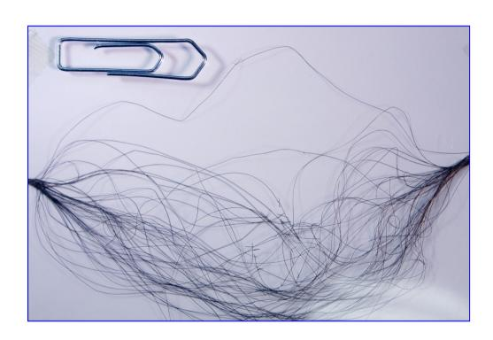
40μm dicke Niobtitandrähte (Supraleiter)
