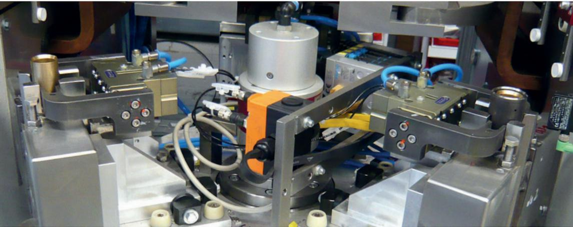
Das CD-Schweißen (Kondensatorentladungsschweißen) ist ein hochwertiges Widerstandsschweißverfahren. Vor allem wegen der kostengünstigen Fertigung bei hohen Stückzahlen und der Möglichkeit des Verschweißens unterschiedlicher Materialpaarungen, stellt es gegenüber herkömmlichen Schweißverfahren einen entscheidenden Wettbewerbsvorteil dar.
