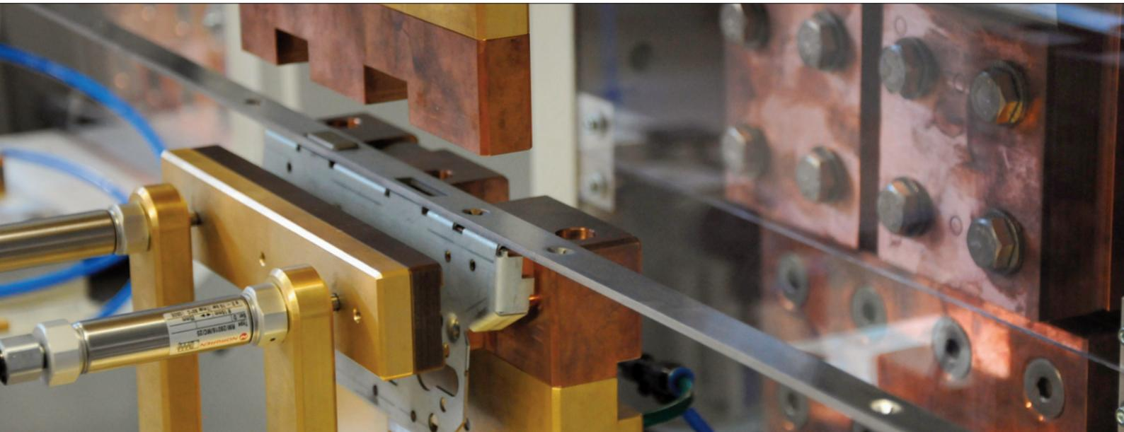
CD-Schweißmaschinen für Einstekschlösser und Mehrpunktverriegelungen
