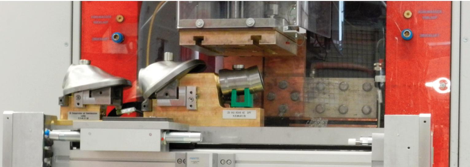
Das CD-Schweißen (Kondensatorentladungsschweißen) ist ein hochwertiges Widerstandsschweißverfahren. Vor allem wegen der kostengünstigen Fertigung bei hohen Stückzahlen und der Möglichkeit des Verschweißens unterschiedlicher Materialpaarungen, stellt es gegenüber herkömmlichen Schweißverfahren einen entscheidenden Wettbewerbsvorteil dar.
