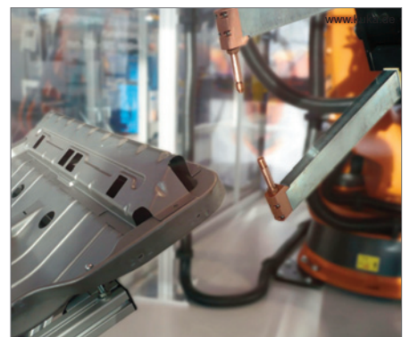
Prototyp der conntronic CD-Schweißzange Für den Produktionseinsatz sind kunden- spezifische Modifikationen notwendig.
